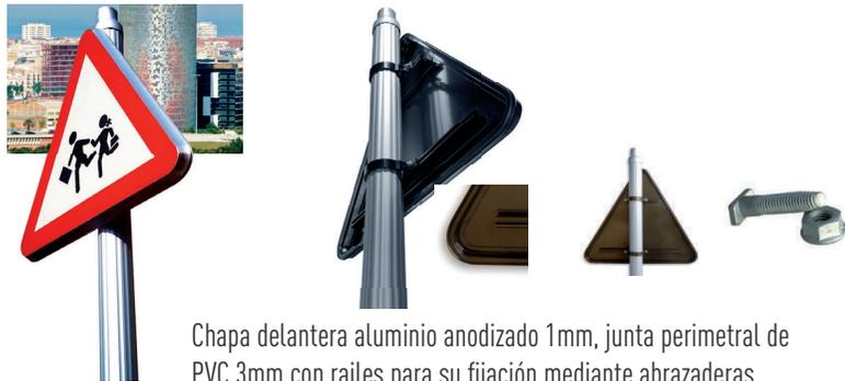
Chapa delantera aluminio anodizado 1mm, junta perimetral de PVC 3mm con railes para su fijación mediante abrazaderas.
