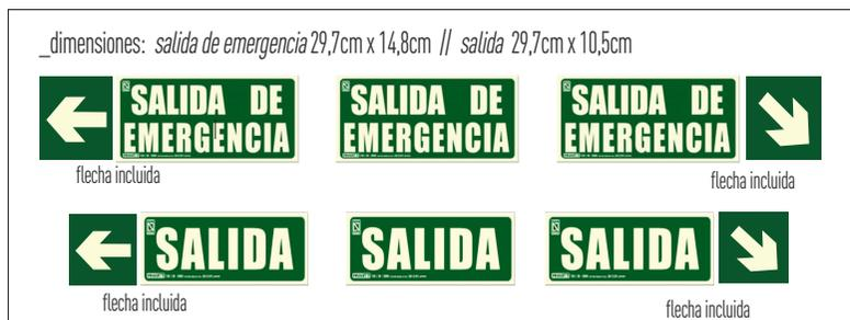
La señalización fotoluminiscente es aquella que después de ser estimulada por una radiación ultravioleta, visible o infrarroja, emite luz sin ningún otro estímulo durante un cierto tiempo, con una luminancia determinada. El acabado fotoluminiscente permite la visualización de la señalización de emergencia en situaciones de ausencia de luz.
