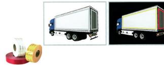
La complejidad visual de la conducción nocturna hace necesario que el vehículo, de grandes dimensiones, esté dotado de indicaciones retroreflectantes, las cuales permiten que los otros conductores puedan ver sus dimensiones en la oscuridad.
